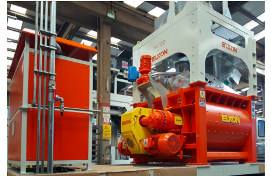
Смесительный блок с двухвалковым смесителем объемом 2 м 3
