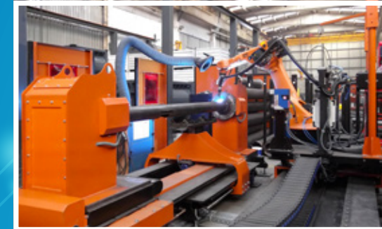
Роботизированная линия по производству шнеков цемента
