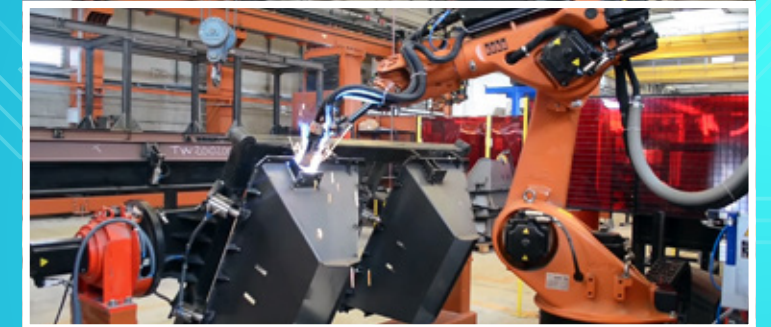
Роботизированная линия по производству выгрузочных горловин бункеров
