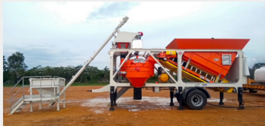
Приобъектный бетонный завод MIX MASTER-30
